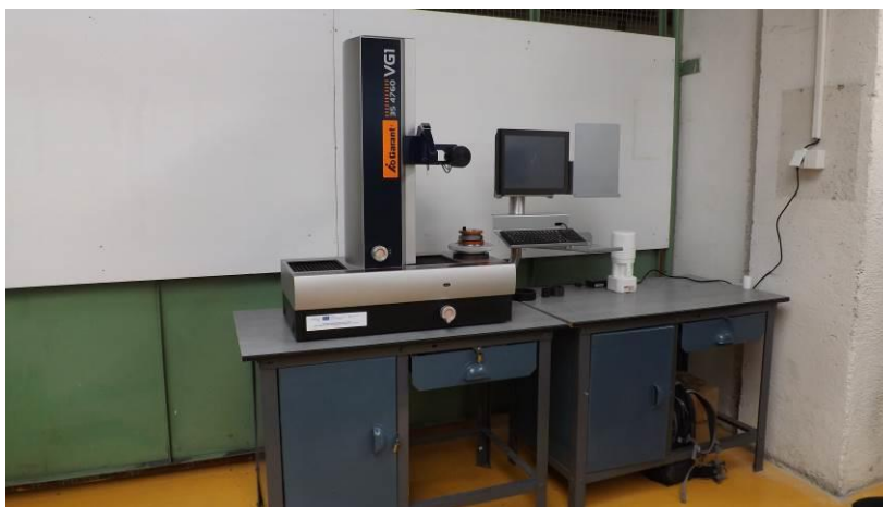
Obr.: Přednastavovací přístroj pro CNC nástroje Hoffmann VG1
