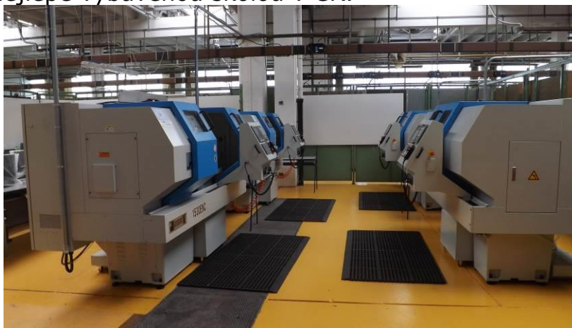
Obr.: Mechatronické soustruhy Jaguar 1530
